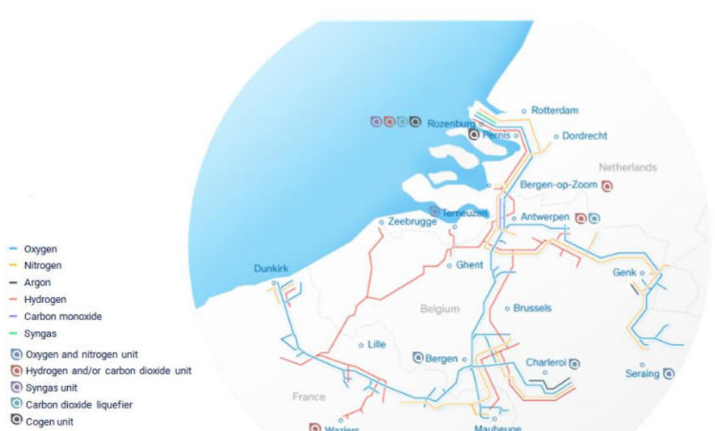
Figure 1 Réseau de pipeline de Air Liquide
